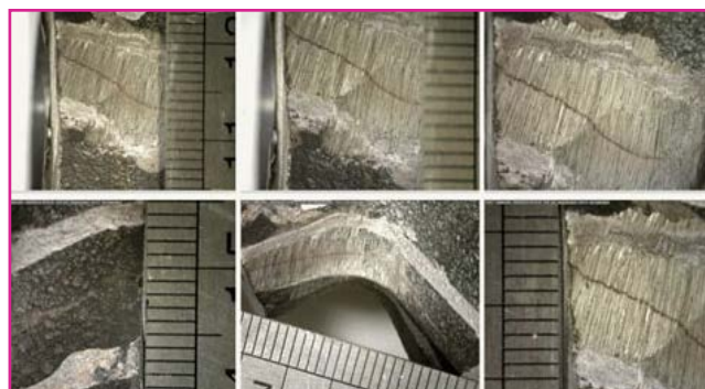
شکل (۲): شکست‌نگاری استریوگرافیک از سطح ترک به وجود آمده در نمونه مورد بررسی از نماهای مختلف.
