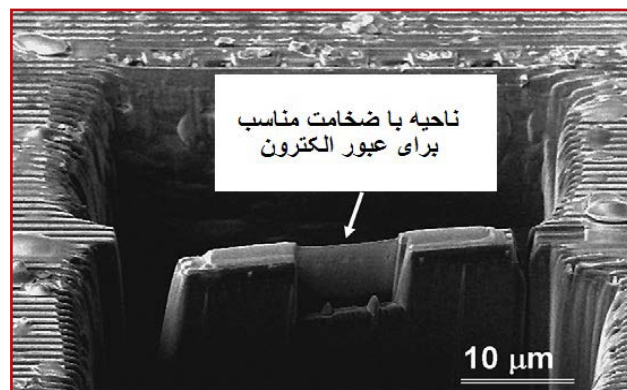
شکل (۱۲): تصویر میکروسکوپ الکترونی روبشی از برش نمونه TEM با FIB [۲].
