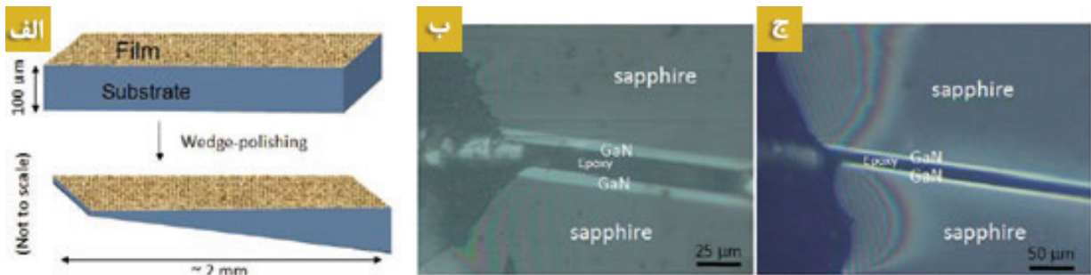
شکل ۵: (الف) نمایی از پولیش گوه‌ای یک نمونه TEM؛ (ب و ج) تصاویر واقعی از نمونه‌های TEM سطح مقطعی از یاقوت یا نیتريد گالیم پولیش شده به صورت گوه‌ای؛ (ب) پولیش سه‌وجهی که به دنبال آن مراحل پیش رو انجام می‌شود؛ (ج) فرز پرتو یونی آرگون به مدت ۲۰ دقیقه در ۴ کیلوولت. به حاشیه‌های پهن فواصل رنگی در لبه‌ها توجه کنید، مناطق شفاف در برابر الکترون توسط پولیش گوه‌ای نشان می‌دهند که کیفیت این مناطق بعد از فرز پرتو یونی بهتر می‌شود.
