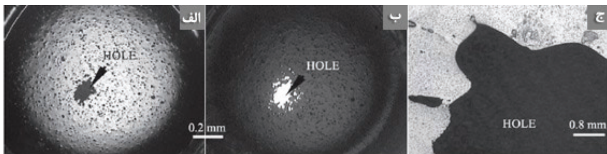
شکل ۲: تصاویری از دیسک TEM الکتروپولیش شده مشاهده می‌شود. در حالت‌های (الف) بازتابی و (ب) عبوری. لبه‌های سوراخ در بزرگنمایی بالا در حالات بازتابی در شکل (ج) نشان داده شده‌است.
