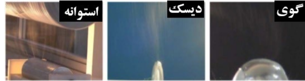
شکل (۹): تصاویر الکتروریسی بدون نازل با استفاده از رشته‌سازهای متفاوت استوانه‌ای، دیسکی و توبی [۱۲].
