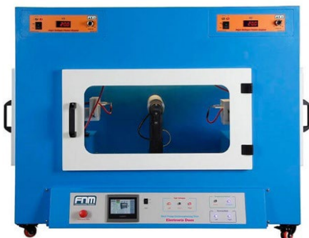
شکل (۱۱): دستگاه الکتروریسی آزمایشگاهی دو پمپ ساخت شرکت فناوران نانومقیاس [۲۵].
